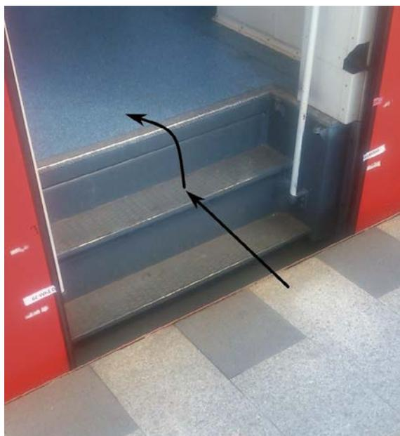
Рис. 6. Неподход вагона к платформе. ЭД4М, Сочи
