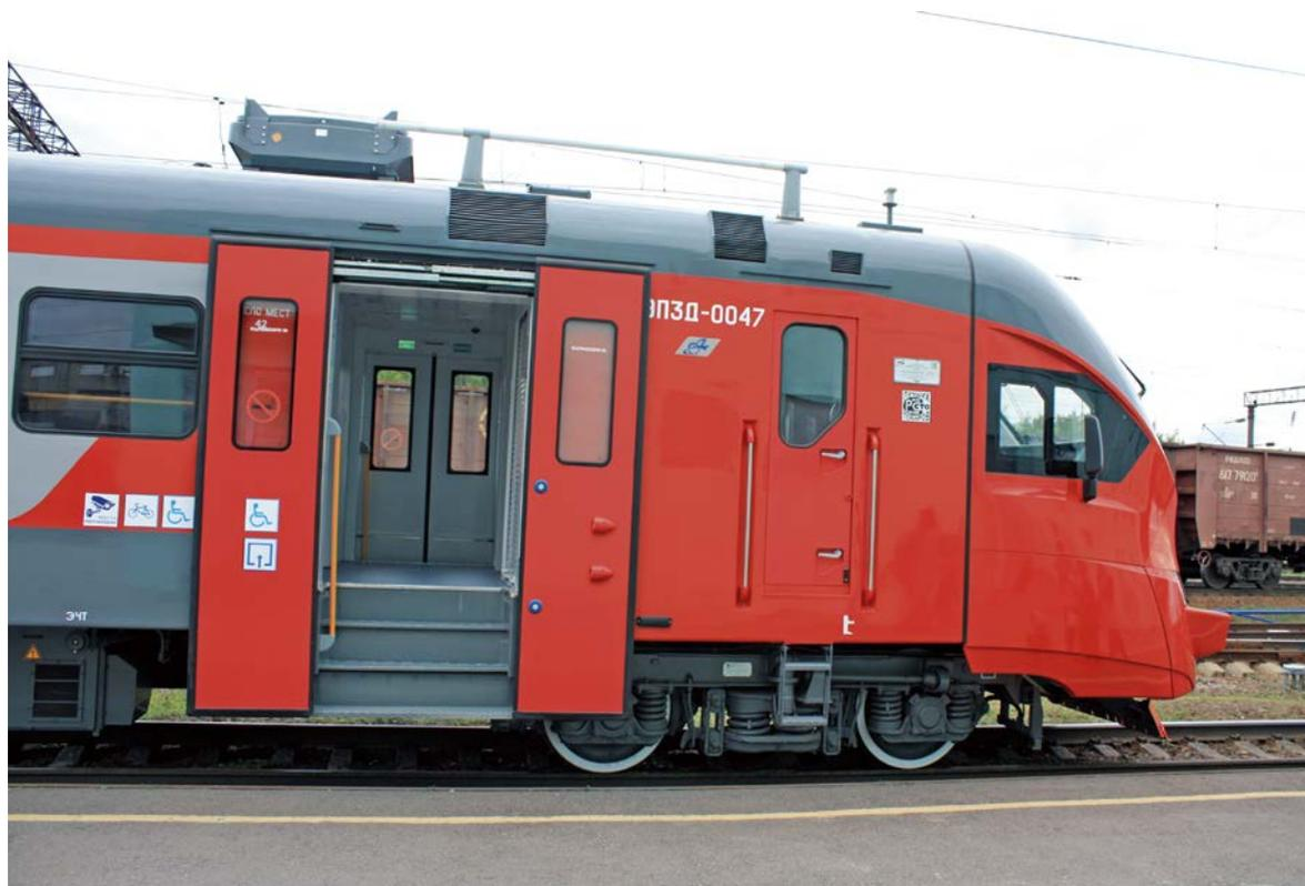
Рис. 4. ЭПЗД на станции Грязи-Воронежские, уровень пола высокий, платформа низкая
