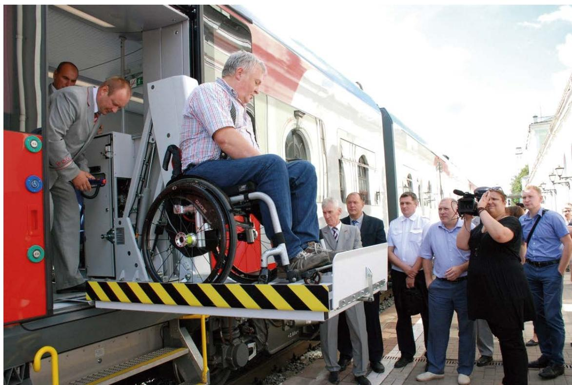
Рис. 13. Имитация доступности с помощью подъемника
